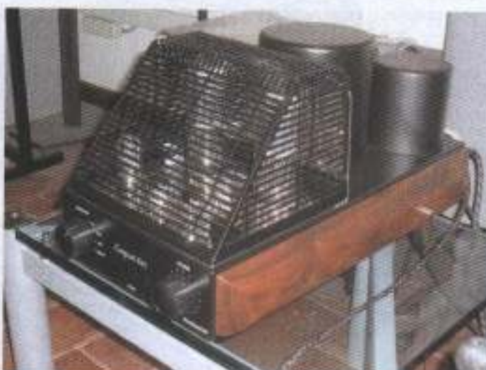
Il Compact 845 con la griglia di protezione: si è in regola con le normative europee sulla sicurezza, ma perde moltissimo del suo fascino.
