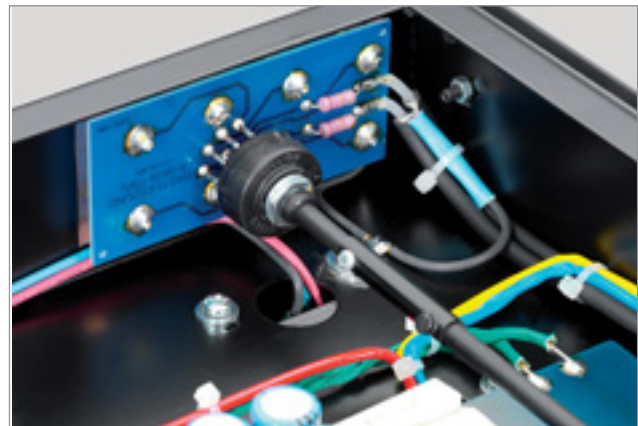
Eingangsumschaltung „vor Ort“ anstatt langer Kabel und damit mangelnder Übersprechdämpfung – sehr gut!
