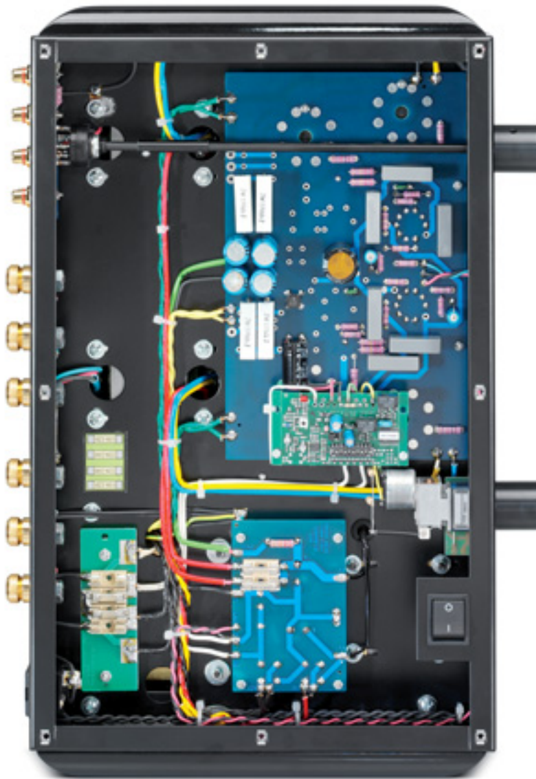
Auf Nummer sicher: In der Stromversorgung dienen Feinsicherungen als Notbremse. Die Audioschaltung ist platinengebunden und trägt auch die Röhrenfassungen.
